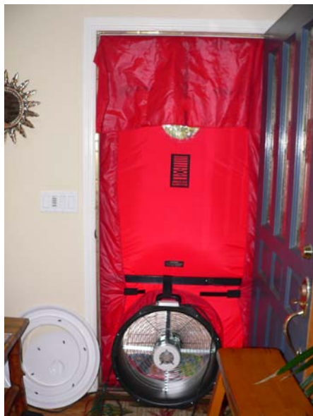
Blower door test underway
